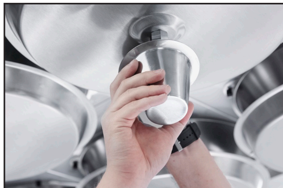
2 Töm innehållet i filtret i ett lämpligt kärl. Stäng ventilen.
