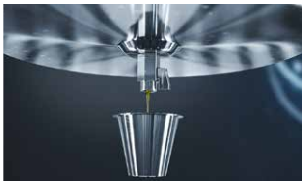
Fettet töms ut från filterhuset i via en ventil
