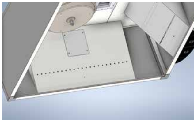
Styrluftsdon monterat på kortsida i en tilluftskåpa.
