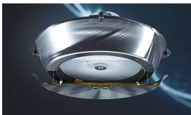
Partiklarna kolliderar med plåten och slungas ut mot filterhusets sidor för att samlas upp i filterhusets uppsamlingsdel.
