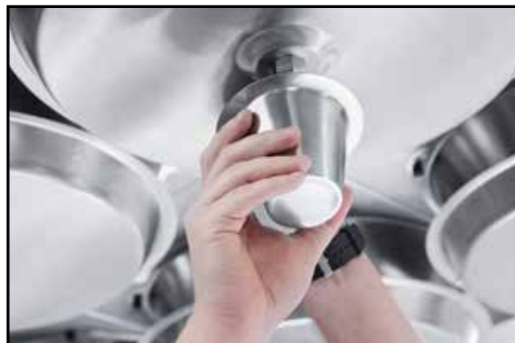
2. Töm innehållet i kondensavskiljaren i ett lämpligt kärl. Stäng ventilen.
