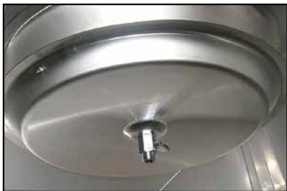
3. Torka rent utsida av kondensavskiljare med mjuk trasa.
