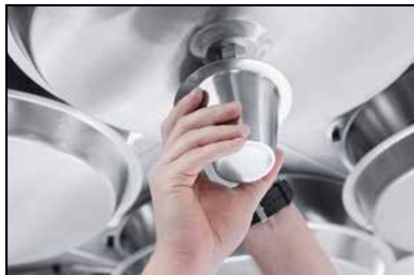
2 Töm innehållet i kondensavskiljare i ett lämpligt kärl. Stäng ventilen.
