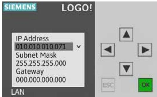
Press OK för att börja ändra IP adress, använd pil knapparna för att ändra nummer och flytta sidled. När rätt IP adress är inmatad, tryck OK.
