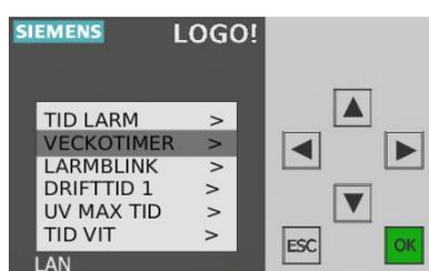
Här har man möjligheten att använda sig av 3st olika tidsprogrammeringar D1, D2 och D3.
