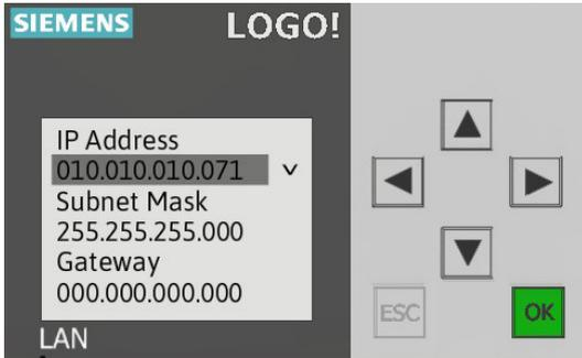
Press OK för att börja ändra IP adress, använd pil knapparna för att ändra nummer och flytta sidled. När rätt IP adress är inmatad, tryck OK.
